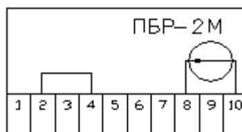
Рисунок 10.3 – Условное графическое обозначение пускателя бесконтактного реверсивного ПБР-2М на схемах электрических принципиальных
